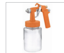
ADL-3 > Ar Direto 098 Capacidade da caneca: 1L Peso: 600g Pressão de trabalho: 25lbs Consumo de ar: 2pcm Duas capas de ar, uma para leque, outra para jato redondo entrada de ar lateral, próprio para trabalhar com compressores de ar direto Bico 1,3mm
