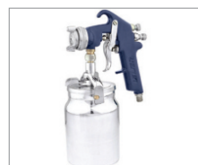
APL-1s > Alta Produção 096 Capacidade da caneca: 1L Peso: 1Kg Pressão de trabalho: 45 a 50lbs Consumo de ar: 10pcm Abertura de leque até aprox. 35cm a uma distância de aprox. 30cm da superfície a ser pintada Bico 1,7mm
