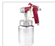
LF-5 > Baixa Produção 099 Capacidade da caneca: 1L Peso: 660g Pressão de trabalho: 25lbs Consumo de ar: 2,5pcm Leque regulável até aprox. 15cm a uma distância de aprox. 30cm da superfície a ser pintada Bico 1,2mm
