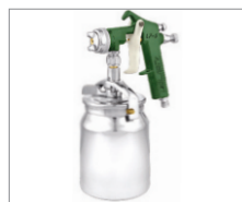
LF-6 > Média Produção 097 Capacidade da caneca: 1L Peso: 800g Pressão de trabalho: 40lbs Consumo de ar: 6,5pcm Leque regulável até aprox. 20cm a uma distância de aprox. 30cm da superfície a ser pintada Bico 1,5mm
