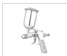
LMG-11 > Gravidade 095 Capacidade da caneca: 150mL Peso: 370g Pressão de trabalho: 15lbs Consumo de ar: 1,5pcm Bico de 0,4 e 0,8mm
