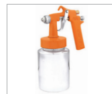
ADL-1 > Ar Direto 090 Capacidade da caneca: 1L Peso: 600g Pressão de trabalho: 25 lbs Consumo de ar: 2pcm Duas capas de ar, uma para leque, outra para jato redondo, próprio para trabalhar com compressores de ar direto Bico 1,3mm
