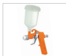
LMG-12 ar direto > Gravidade 098 Capacidade da caneca: 200mL Peso: 370g Pressão de trabalho: 15lbs Consumo de ar: 1,5pcm Caneta em nylon, próprio para trabalhar com compressores de ar direto Bico de 0,4 e 0,8mm
