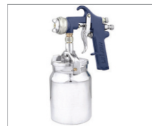
LM-4 > Alta Produção 096 Capacidade da caneca: 1L Peso: 1Kg Pressão de trabalho: 45lbs Consumo de ar: 10pcm Leque regulável até 25cm a uma distância aprox. 30cm da superfície a ser pintada Bico 1,7mm
