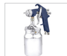
APL-2s > Alta Produção 096 Capacidade da caneca: 1L Peso: 1Kg Pressão de trabalho: 45 a 50lbs Consumo de ar: 10pcm Abertura de leque até aprox. 35cm a uma distância de aprox. 30cm da superfície a ser pintada com regulagem de ar no cabo Bico 1,7mm
