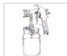
APL-2 > Alta Produção 095 Capacidade da caneca: 1L Peso: 1Kg Pressão de trabalho: 45 a 50lbs Consumo de ar: 10pcm Com difusor para um leque mais pulverizado. Abertura de leque até aprox. 35cm a uma distância de aprox. 30cm da superfície a ser pintada com regulagem de ar no cabo Bico 1,7mm
