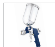
LMG-4 > Gravidade 096 Capacidade da caneca: 550mL Peso: 595g Pressão de trabalho: 30lbs Consumo de ar: 2,5pcm Abertura de leque até aprox. 25cm a uma distância de aprox. 30cm da superfície a ser pintada Bico de 1,5mm
