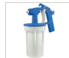
ADL-150 N > Ar Direto 097 Capacidade da caneca: 550mL Peso: 455g Pressão de trabalho: 25lbs Consumo de ar: 2pcm Capa de ar com abertura de leque regulável capa de ar redonda, próprio para trabalhar com compressores de ar direto Bico de 0,4 e 0,8mm
